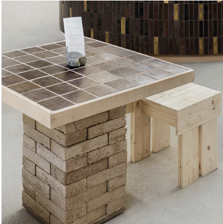
Fliesen hergestellt aus Materialaushub der Wiener U-Bahn, Ziegel aus Bierträger & Bauschutt (Abbildung: Studio dreiSt., Biofabrique)
