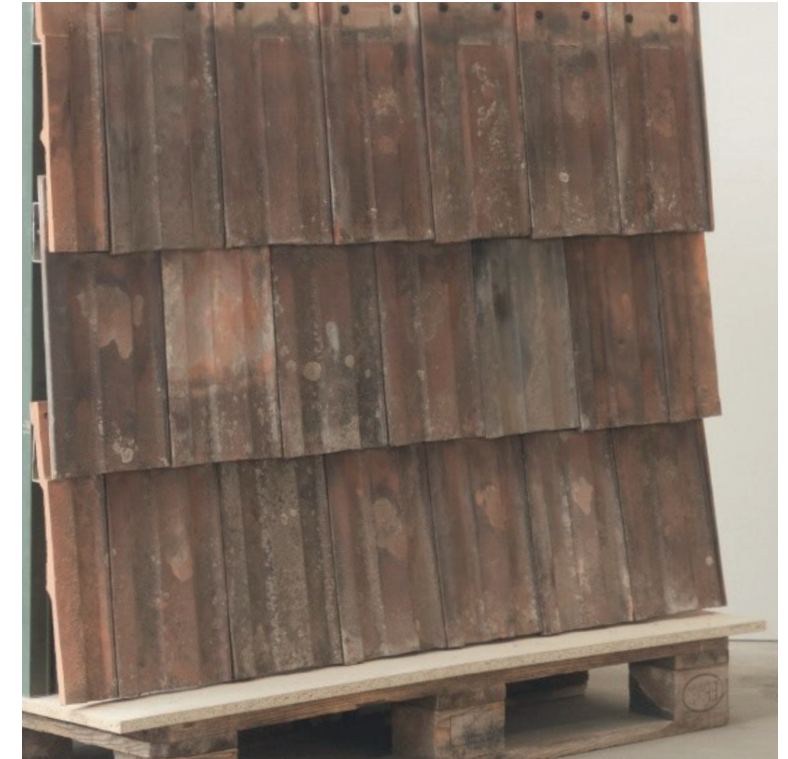
Wiederverwendung von Wiener Dachziegeln (Abbildung: Hochbau & Entwerfen, TU Wien)
