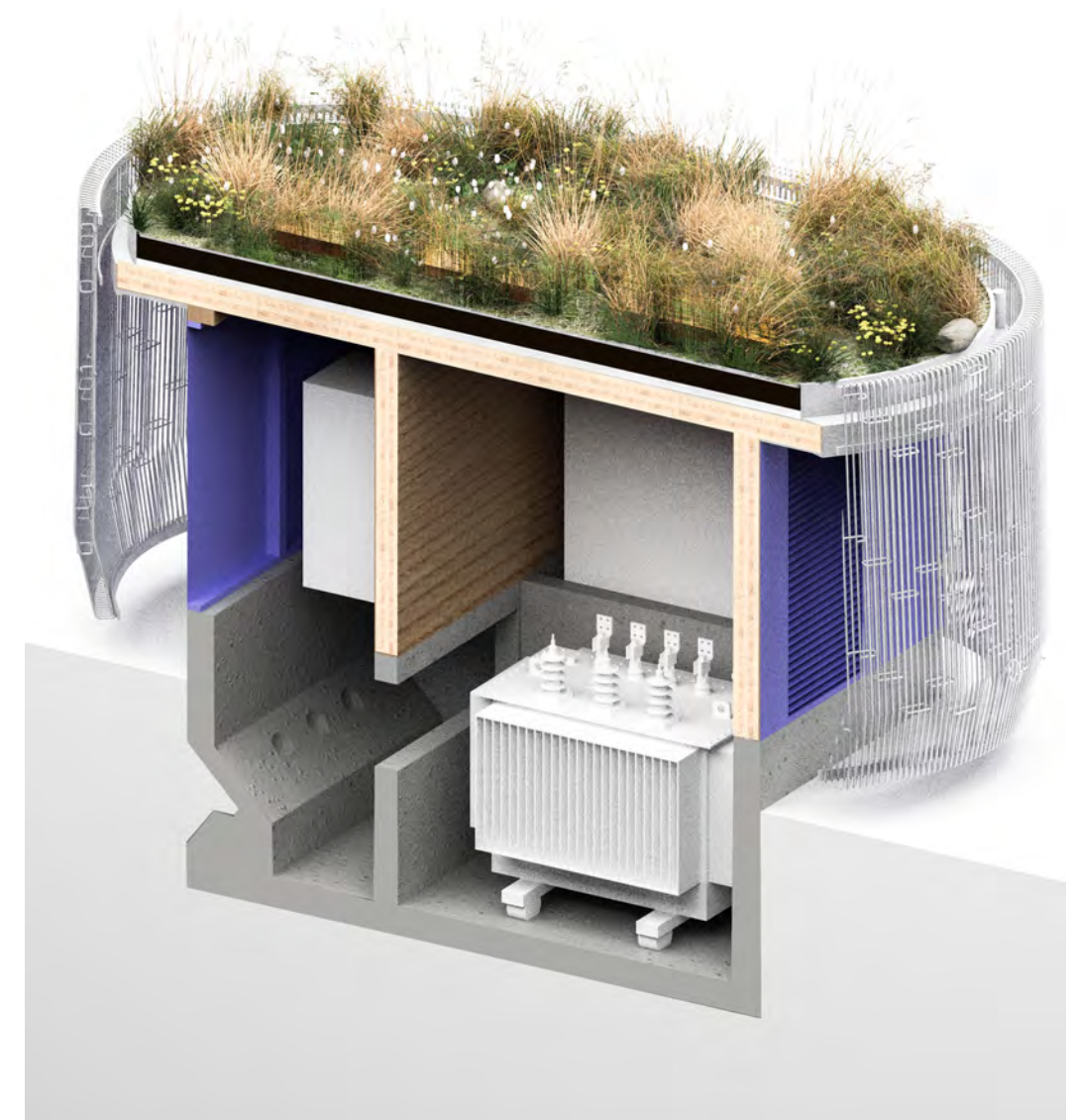
Längsschnitt Trafostation „stadtflimmern“
